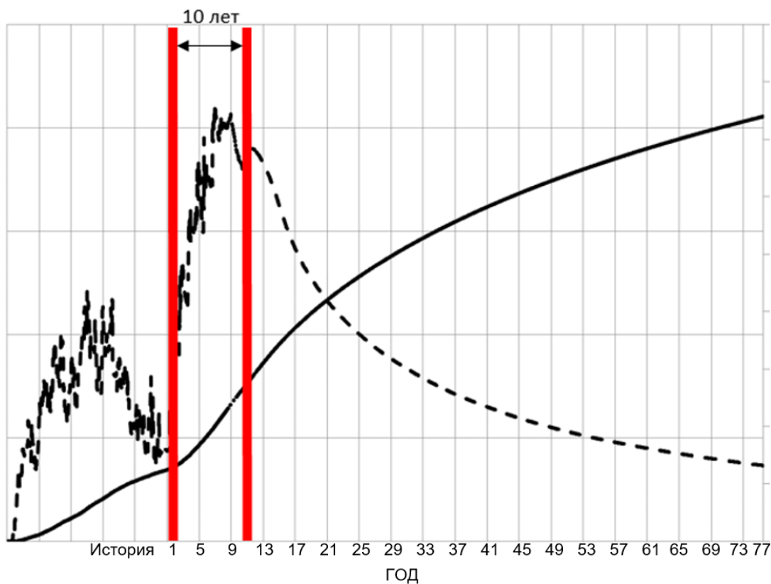
Рисунок Д.1 – Прогноз добычи нефти с применением закачки горячей воды
